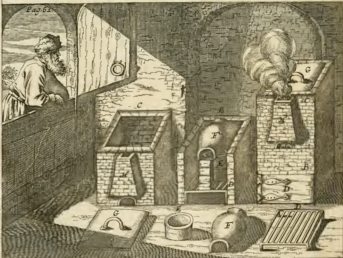
A. Ist der Ofen wie er in der arbeit steht. C. Ist das obertheil des Ofens. G. der Deckel dar mit der Ofen oben gedecket wird. B. Ist der Untertheil des Ofens wie er D. Der roß in dem Ofen. H. der Herd. wann kohl in dar in sein und in voller arbeit Ofen ohne die vorder wand anzu sehen. E. der Müßel so auff den herd gehört: steht. H. das rauch fänglein an dem Ofen.
