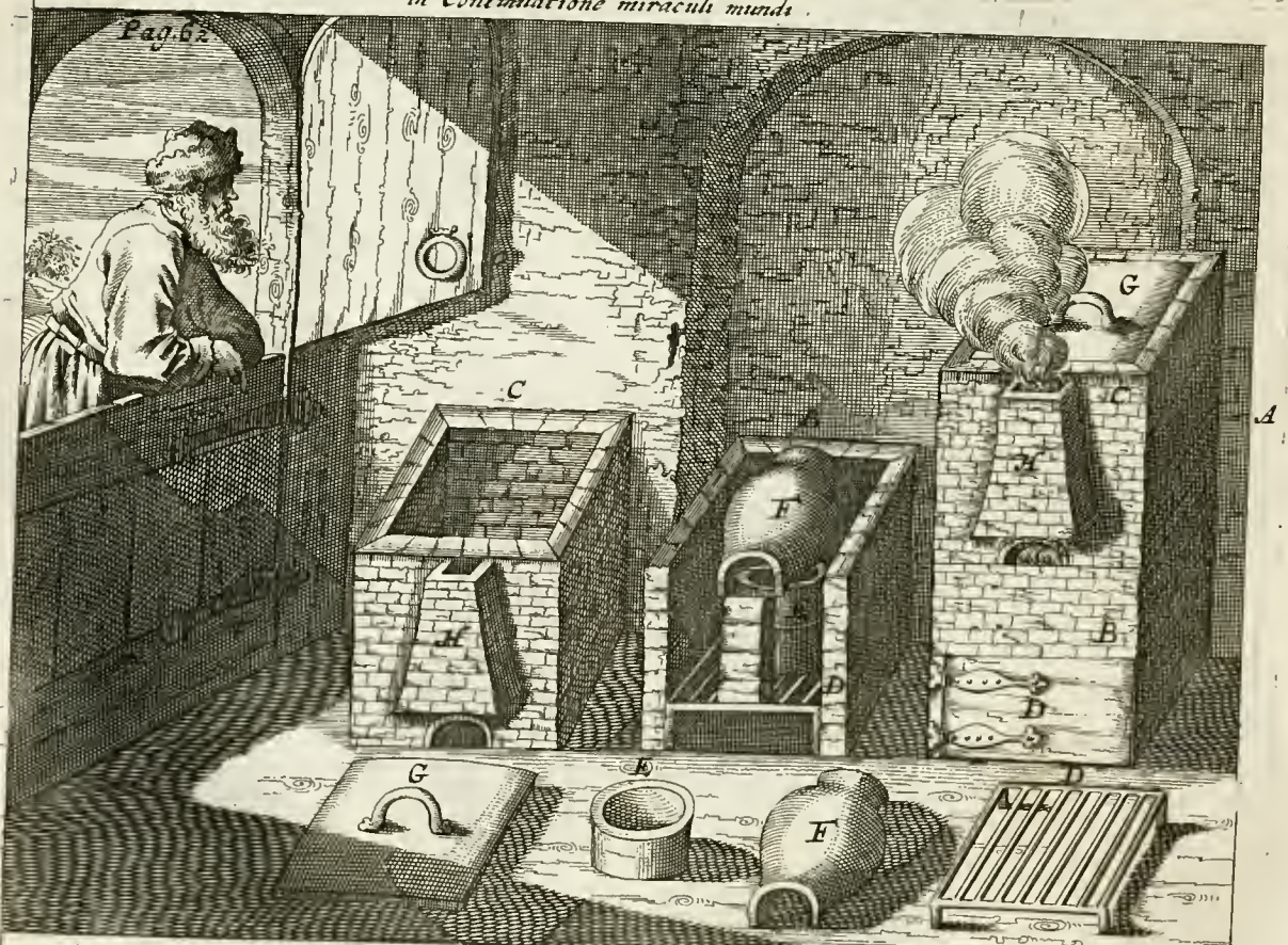
A. Ist der Ofen wie er in der arbeit steht. B. Ist das obertheil des Ofens. C. Ist der untertheil des Ofens wie er D. Der rostin dem Ofen. E. der Herd. F. der Muffel so auff den herd gehöret. G. der Deckel dar mit der Ofen oben gedecket wird wann kohlen darinnen und in voller arbeit steht. H. das rauch fänglein an dem Ofen.
