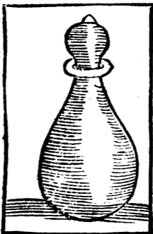
Vas cæcum, sive cucur- bita cum a- lembico sine rostro, ita quod sint duæ cucur- bitæ, una su- per imposita alteri.
