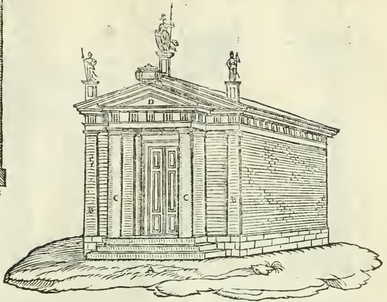
**I** L Secondo è detto faccia in colonne, perche dinanzi à ciascuno de' pilastri, che sono del primo aspetto è contraposta una colonna, & sopra di essa si appoggia un frōtespicio: & questa forma è detta da' Greci πρόσυλος.
