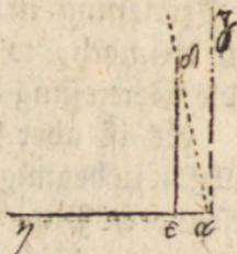
Nun ziehe man  $\alpha\eta$  als eingebildete Erdlinie, und  $\alpha\beta$  gegen dieselbe senkrecht, man mache den Winkel  $\eta\alpha\beta$  gleich 70 Graden, dem Komplement von 20, weil alsdann  $\alpha\delta$  mit  $\alpha\beta$ , die gegen  $\alpha\eta$  senkrecht ist, 20 Grade
