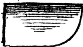
dünne Eisen von gutem Stahle gemacht und gleichet gegenwärtiger Figur. Es kan ungesehr 3. Finger breit seyn, einer halben
